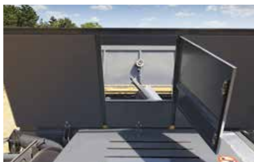
Juurdepääs punkrile selle koristamiseks või kontrollimiseks toimub lihtsalt mootorruumist
